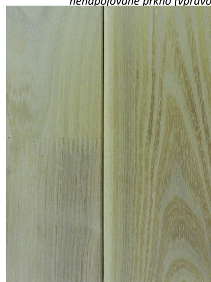
Cinkované prkno (vlevo), hladké nenapojované prkno (vpravo)
