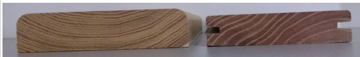
Nenapojované prkno (vlevo), cinkované prkno s drážkou pro T-klik (vpravo)
